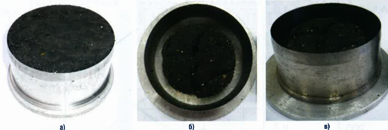
Рисунок 2 Образец механически обезвоженного осадка в пробоотборном кольце: а) - при объемной влажности W^* = 77\% ; б) и в) - после высушивания до постоянной массы, W^* = 0\% .
