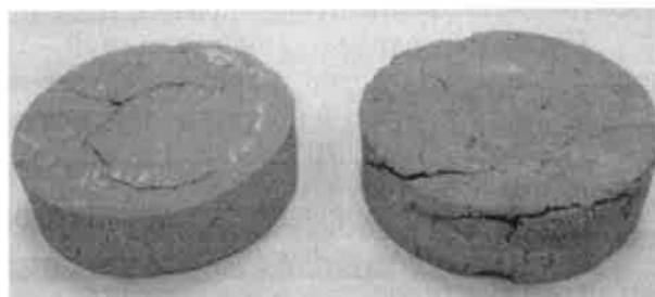
Рис. 4. Образцы глины нарушенной (а) и ненарушенной (б) структуры после высыхания в термостате (на поверхности образца «а» остались следы фильтровальной бумаги в виде светлых пятен)
