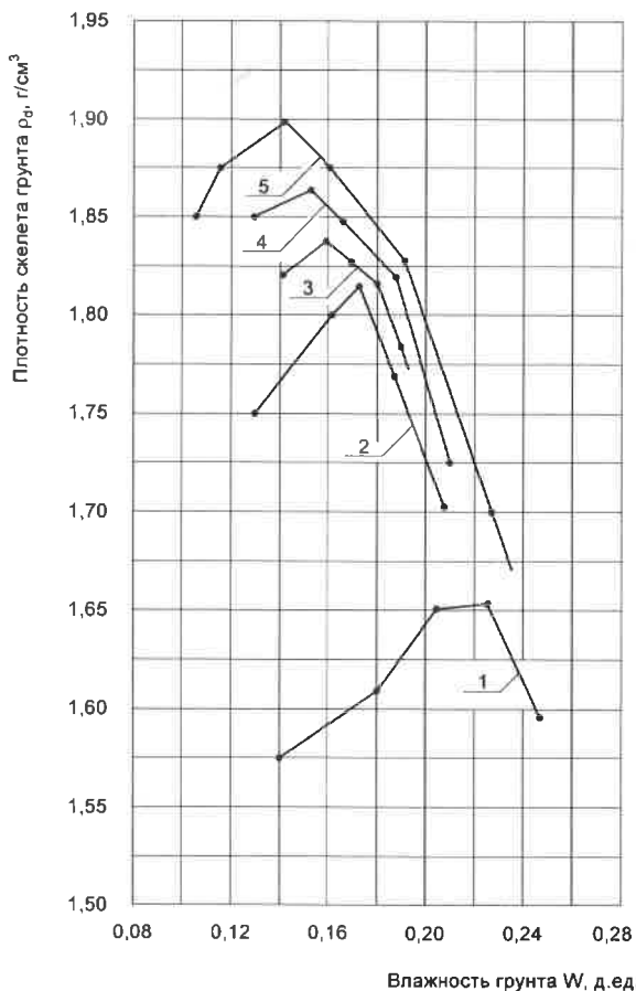
Рисунок 1. Сравнение результатов лабораторного уплотнения песчанистого суглинка различными методами, использующими ударное воздействие на грунт: 1 — стандартный метод AASHTO; 2 — метод Проктора; 3 — ГОСТ 22733-2002; 4 — калифорнийский метод; 5 — модифицированный метод AASHTO
