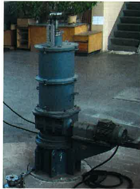
Рис. 5. Прибор для лабораторного определения максимальной плотности и коэффициента уплотнения крупнообломочных грунтов:
