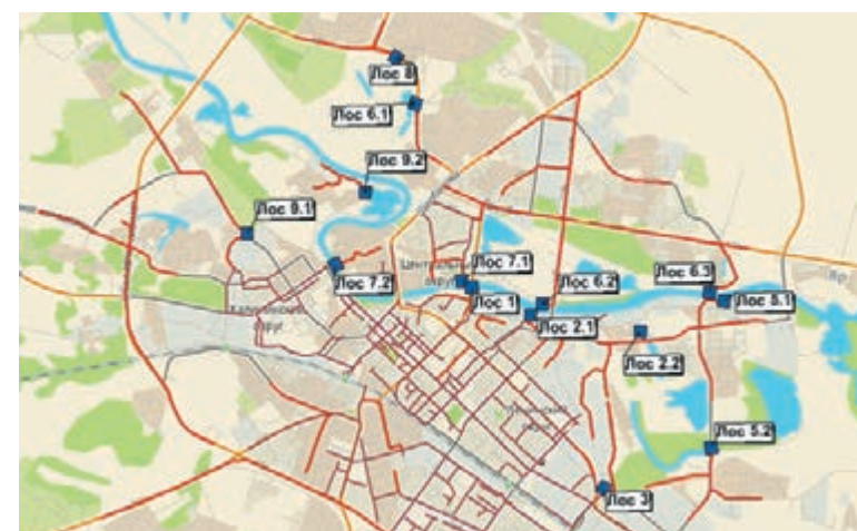
Рисунок 2. Развитие системы дождевой канализации с размещением ЛОС:
