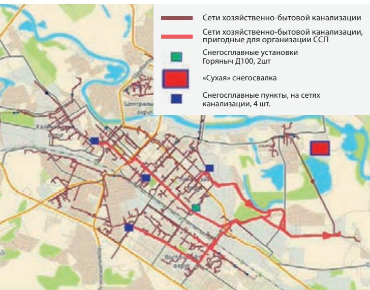
Рисунок 3. Перспективная схема расположения сооружений утилизации снежной массы.
