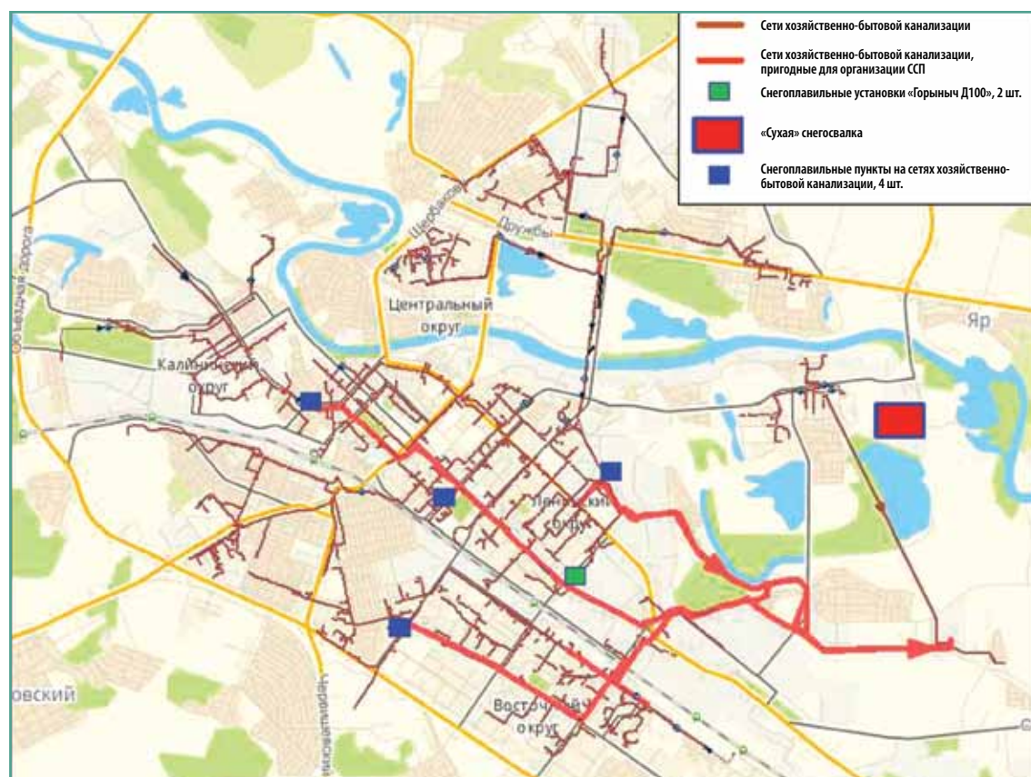
Рис. 2. Перспективная схема расположения сооружений утилизации снежной массы в Тюмени
