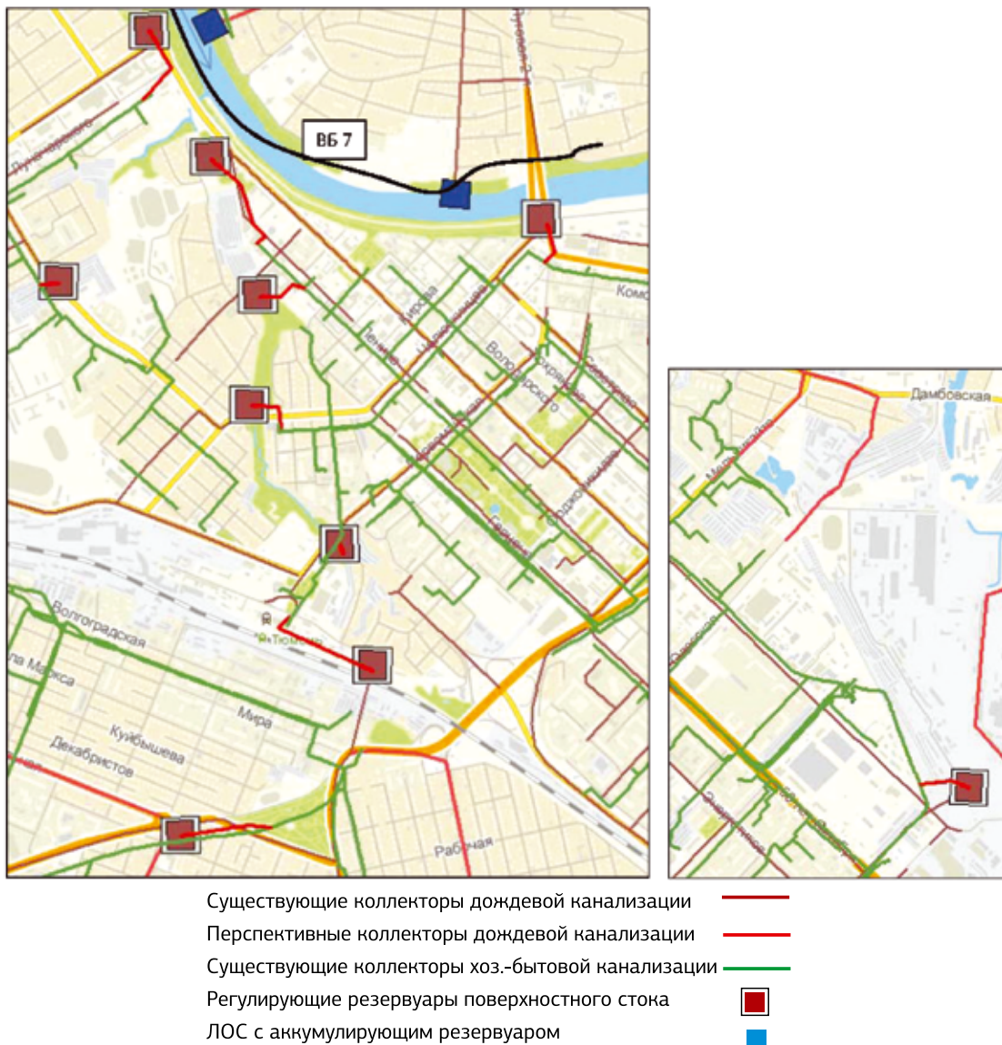
Рисунок 4 Схема размещения регулирующих резервуаров на бассейнах ВБ1, ВБ2, ВБ3 и ВБ10 (центральная часть города).
