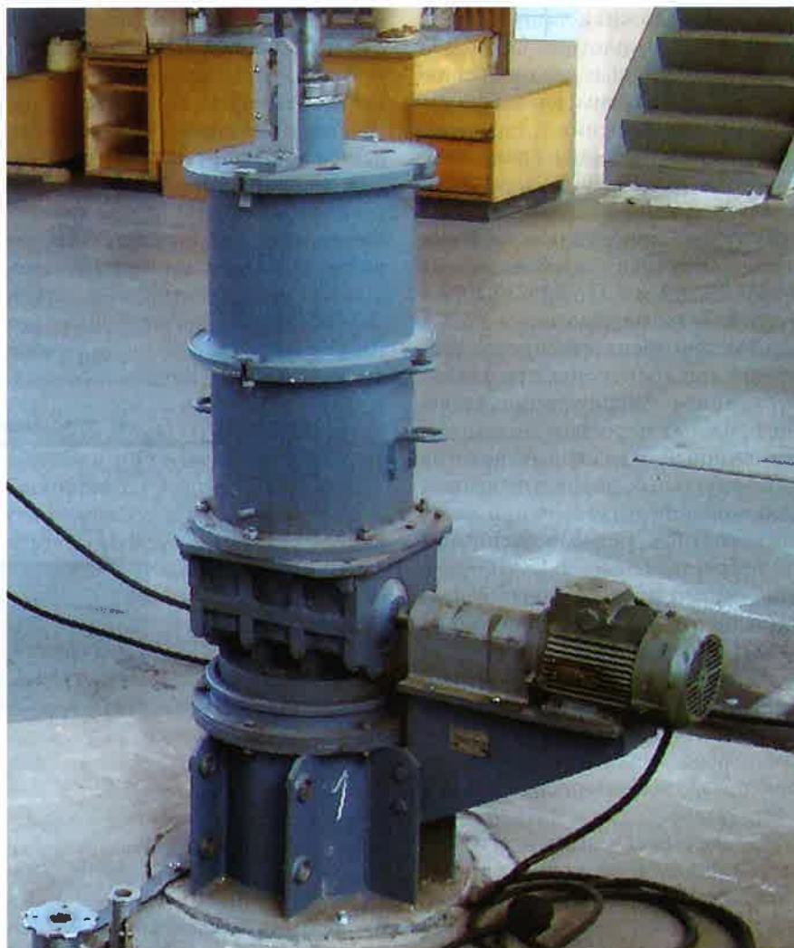
Рис.1. Прибор для лабораторного определения максимальной плотности и коэффициента уплотнения крупнообломочных грунтов
